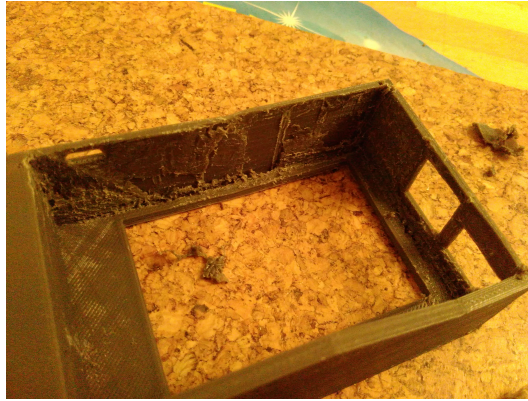
Abbildung 26: Halterung RaspberryPi, ausgedünnte Seitenwände
