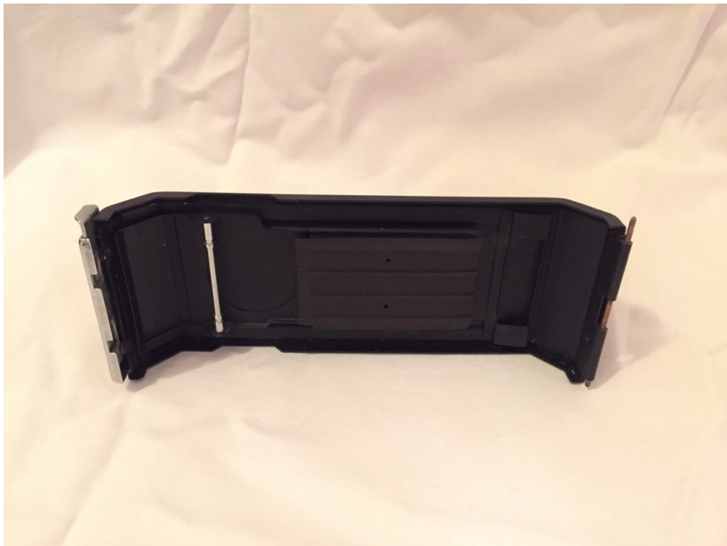
Abbildung 8: Abgenommene Rückwand, das Scharnier ist rechts zu erkennen
